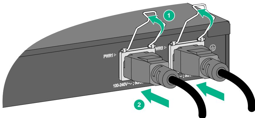
图2-13 交流电源线固定示意图
